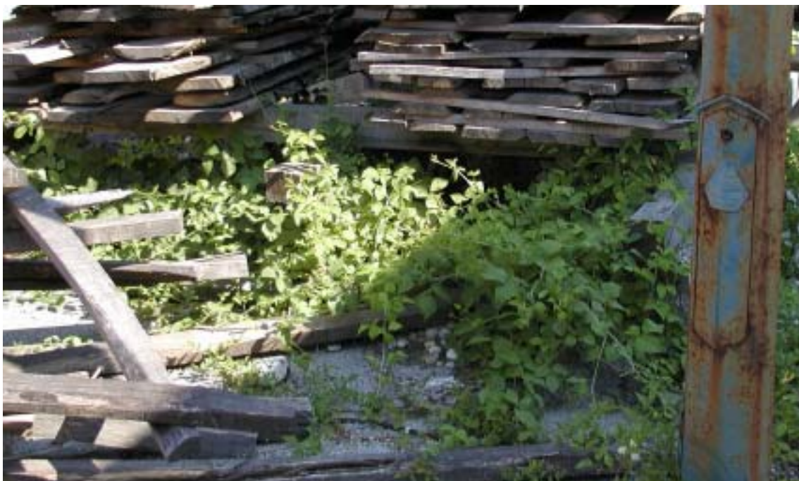
Slika 5. Sprječavanje strujanja zraka ispod složajeva zbog korova
