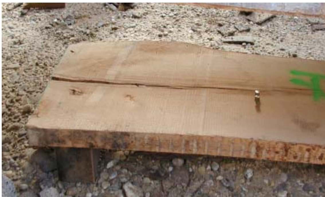
Slika 11. Izgled i smještaj elektroda na uzorku
