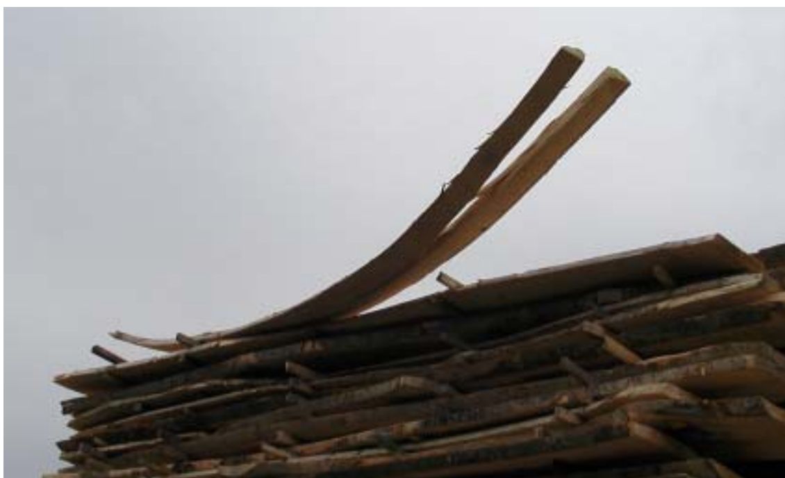
Slika 2. Nepokriven složaj i greške koje takav način slaganja uzrokuje (raspukline, izbočenost, sabljatost)
