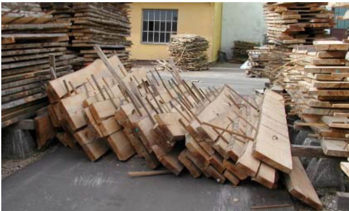
Slika 3. Nepravilno slaganje složaja uslijed čega je došlo do urušavanja
