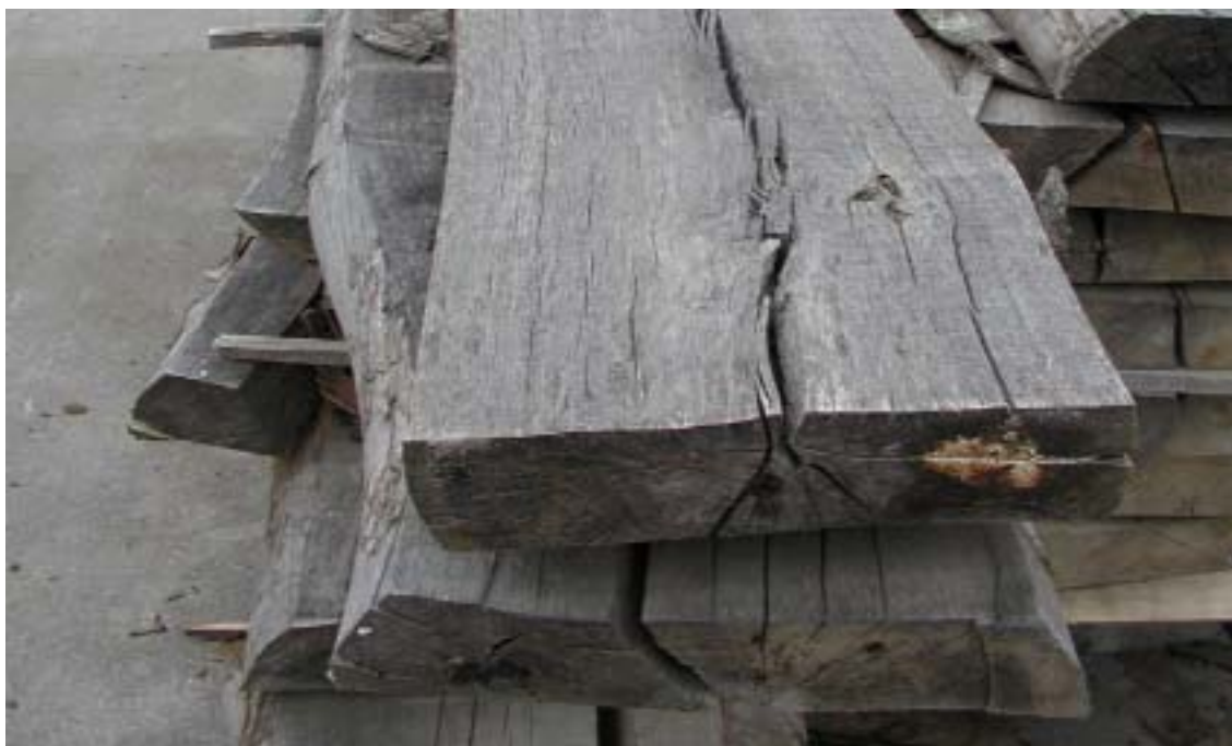
Slika 4. Složaj izložen utjecaju sunca i greške koje takav način uzrokuje (sivljenje, površinske i čeone pukotine, raspukline)
