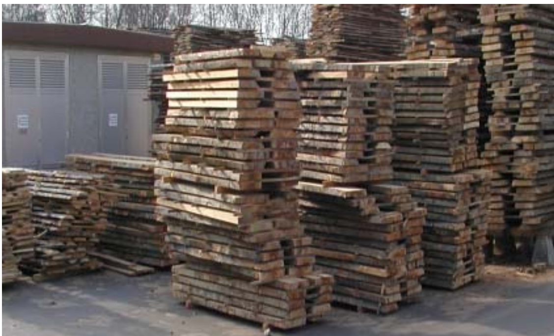
Slika 1. Neadekvatno slaganje složajeva (složajevi su u doticaju sa tlom)
