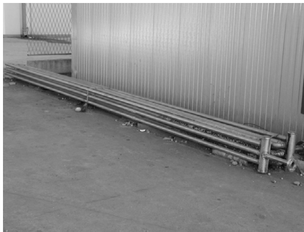
Slika 9. Grijači za indirektno parenja – izvedba od nehrđajućeg čelika Figure 9 Stainless steel heaters for indirect heating
