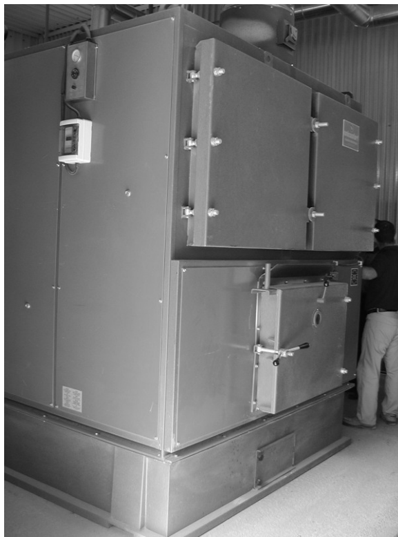
Slika 12. Peć manje snage – često rješenje u manjim drveno industrijskim pogonima (kasnije problem zbog premale snage)
