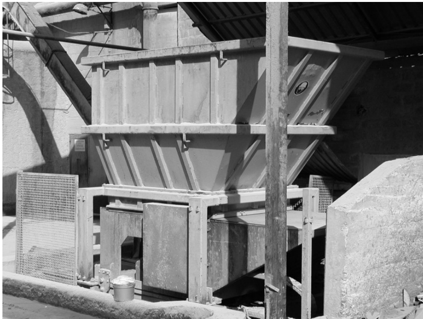
Slika 25. Usitnjavanje krupnog pilanskog ostatka za spaljivanje u kotlovnici
